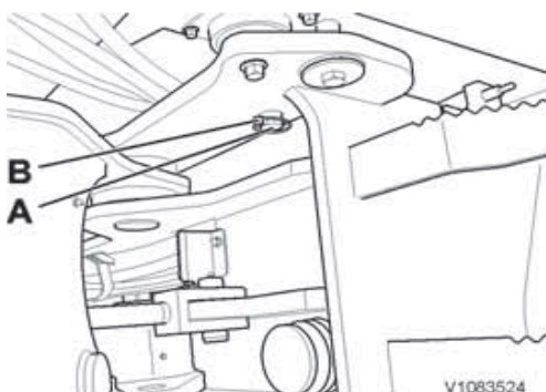
Position de remisage de vis de blocage (A) et de goupille de blocage (B)
